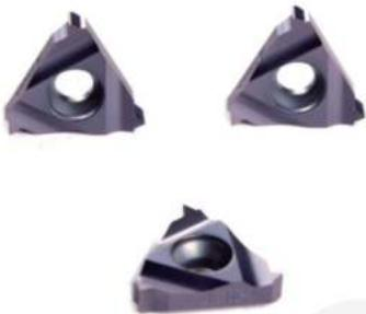
CP2630: 中低速不锈钢及钢的加工, VC=50~150m/min; 4XX不锈钢(不锈铁)加工, 加工高温合金和双向不锈钢的性能首选;
